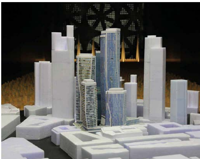
Bild 3 Hochhausensemble FOUR im Windkanal (Quelle: Wacker Ingenieure) FOUR high-rise ensemble in the wind tunnel
